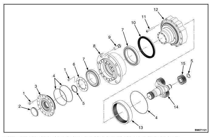
NOTE: LEFT REDUCTION GEAR SHOWN. THE COMPONENTS FOR RIGHT SIDE ARE SAME.
